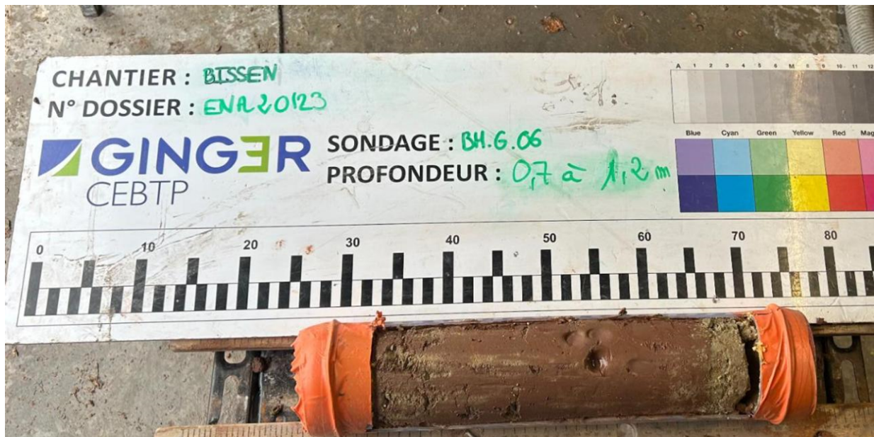
Figure 4-9 : BH.G06 // 0.7 – 1.2 m // Faciès-type du km1-c : Argile sableuse plastique lie-de-vin
