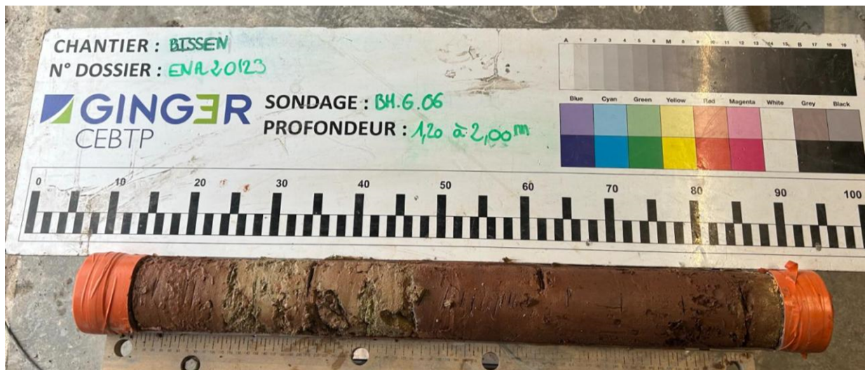
Figure 4-10 : BH.G06 // 1.2 – 2.0 m // Faciès type du km1-b Sable gréseux gris-rougeâtre (1.2 – 1.6 m), grès friable lie-de-vin (1.6 – 2.0 m)
