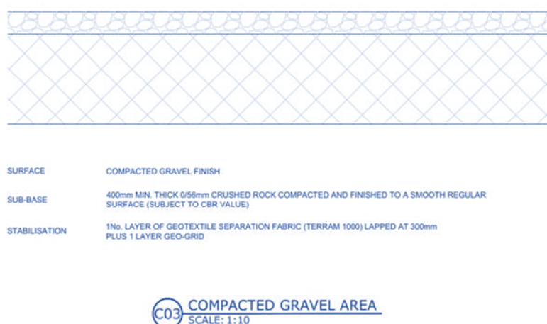
Figure 6-2 : Coupe-type du cheminement en gravier projeté autour des bâtiments
