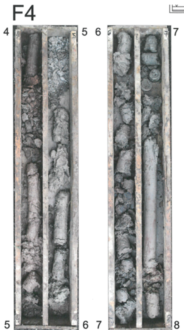
Figure 4-4 : Campagne Fugro // Sondage carotté F4 // 4.0 – 8.0 m // Echantillon d'argile et marne grises appartenant à la formation km3
