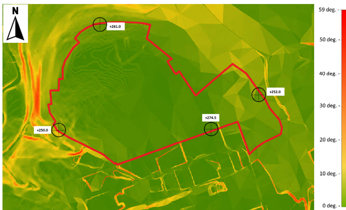
Figure 2-2 : Carte des pentes annotée avec les élévations minimales et maximales de la parcelle (N, W, S, E) – source : map.geoportail.lu
